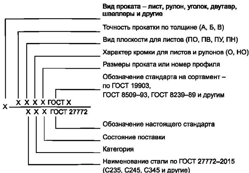
Прокат горячекатаный листовой повышенной точности (А), высокой плоскостности (ПВ), с обрезной кромкой (О), размерами (10×1000×2000) мм по ГОСТ 19903, из стали С390, в улучшенном состоянии (У), категории 6:
